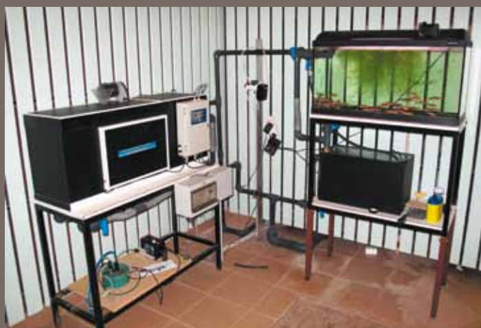
Dans le détecteur biologique de pollution des eaux ou « truitomètre », des vairons, petits poissons de rivière, attestent par leurs mouvements de la qualité de l'eau captée à la source du Lez.
