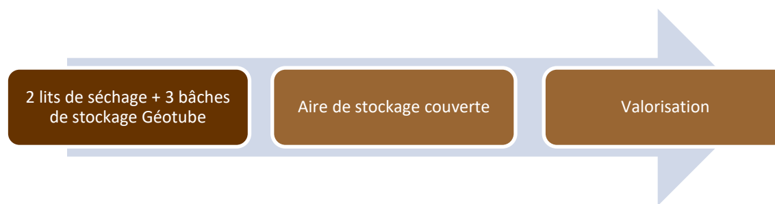
Figure 67 : Synoptique de fonctionnement de la STEP – Montaud
