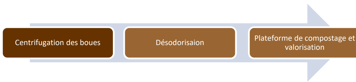
Figure 74 : Synoptique de fonctionnement de la STEP – Fabrègues
